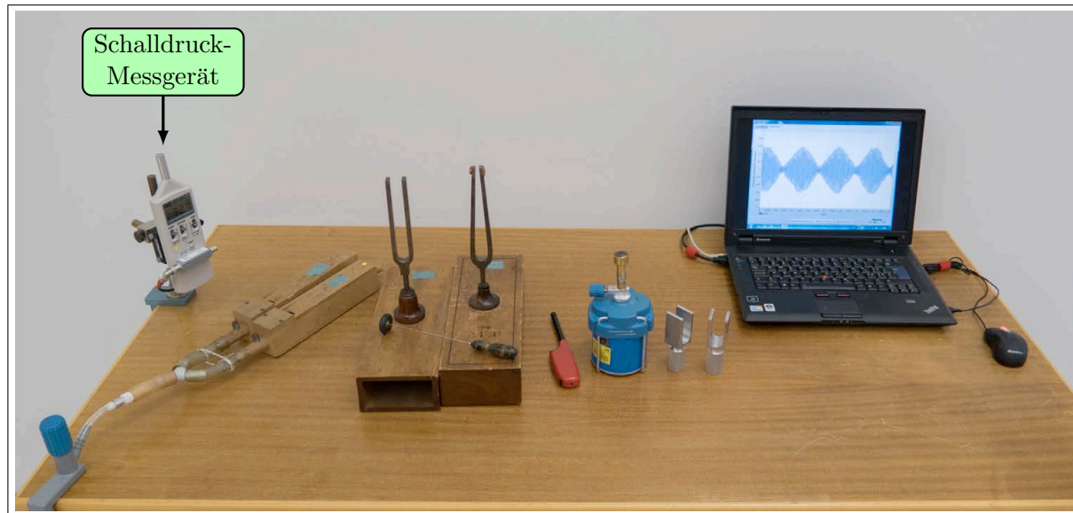
Abbildung 1: Versuchsaufbau „Schwebungen auf PC“
