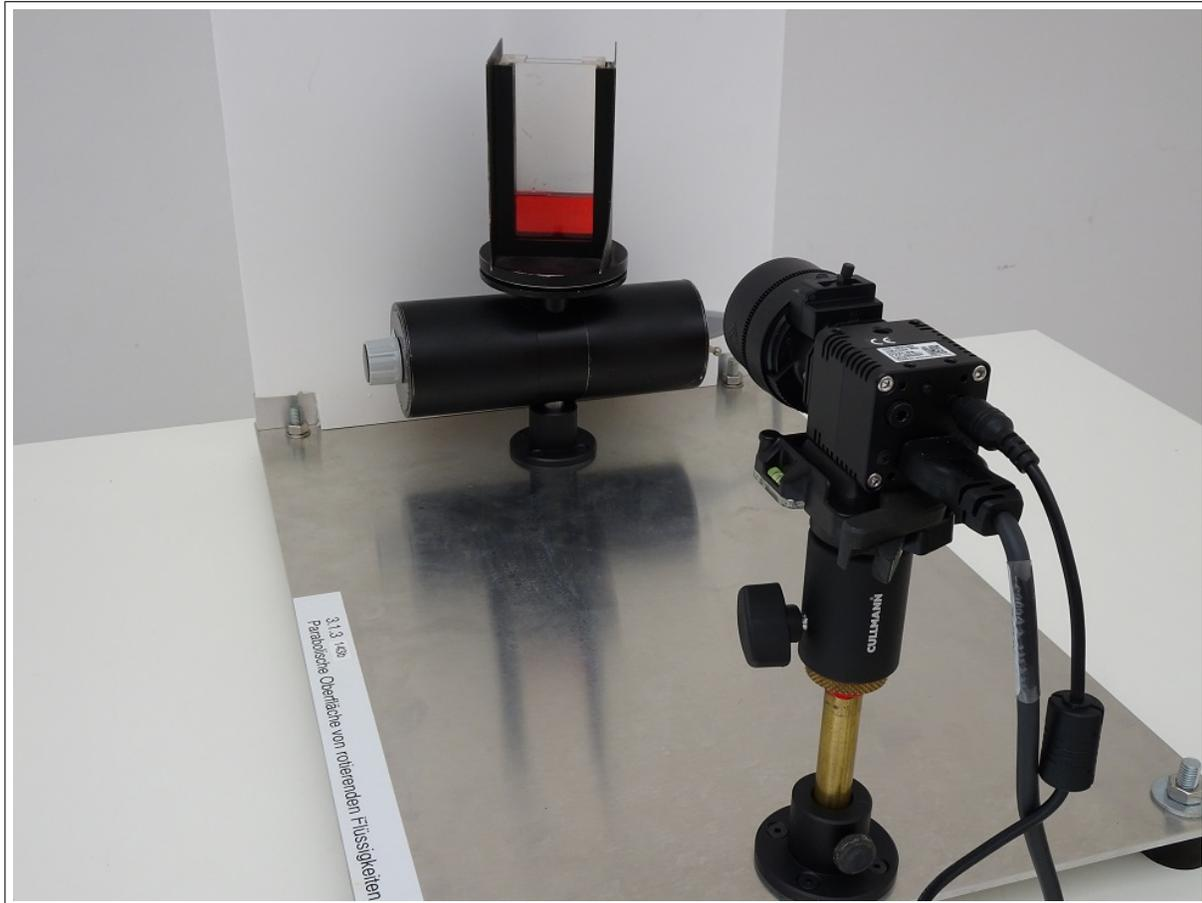
Abbildung 2: Versuchsaufbau zur Erzeugung einer parabolischen Wasseroberfläche
