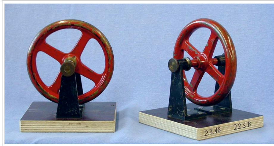
Abbildung 2: Zwei Laufräder: Beide sind statisch, aber nur eines auch dynamisch ausgewuchtet.
