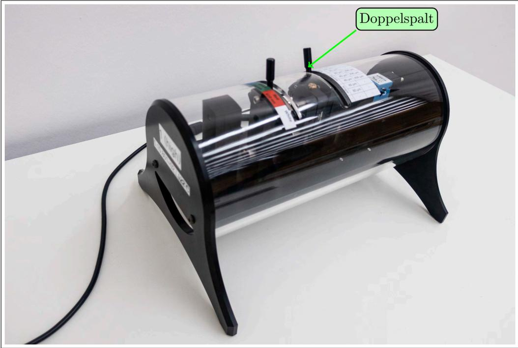
Abbildung 2: Beugung am Spalt: Detailansicht 1
